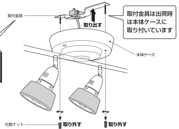
**警告** 取り出した取付金具だけを持って製品を持ち上げないでください。電源コードに製品の重量が掛かり断線や落下によるケガのおそれがあります。
