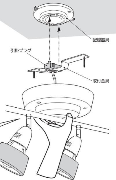
**警告** 必ず製品(本体ケース部分)をしっかりと持って、電源コードに負荷が掛からないように(常に製品を支えた状態で)作業してください。取付金具だけを持っての作業は決してしないでください。
