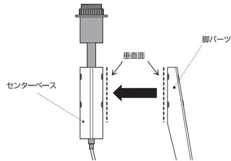
次に、それぞれのネジ穴の位置に注意しながら固定ネジを差し込み、付属の六角レンチで締め付けて、脚パーツをセンターベースに取り付けます。
