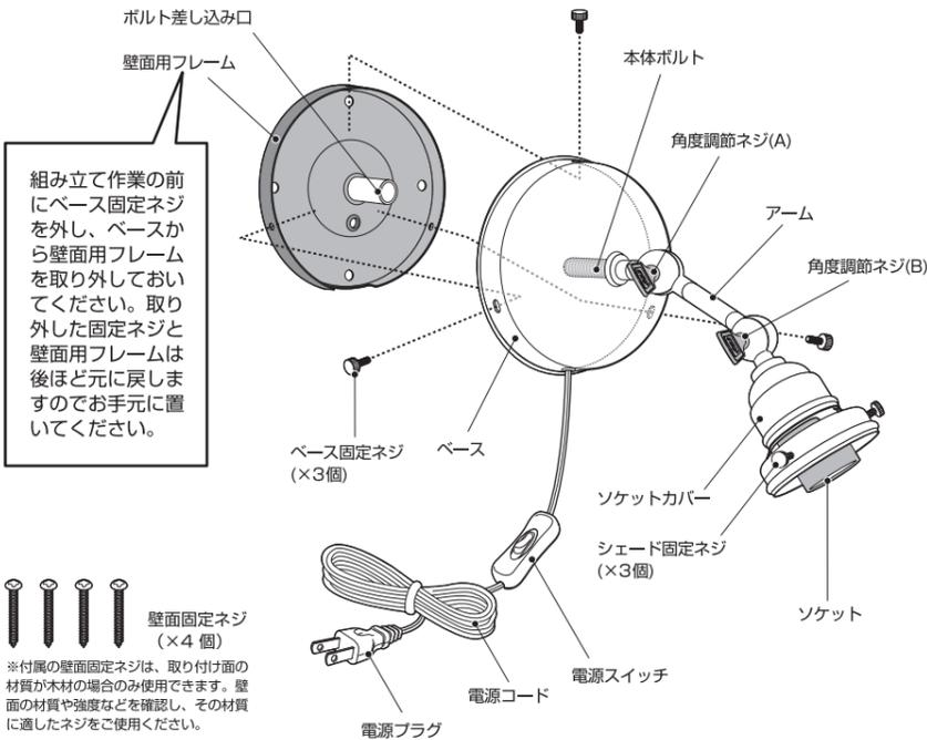
組み立て作業の前にベース固定ネジを外し、ベースから壁面用フレームを取り外しておいてください。取り外した固定ネジと壁面用フレームは後ほど元に戻しますのでお手元に置いてください。
