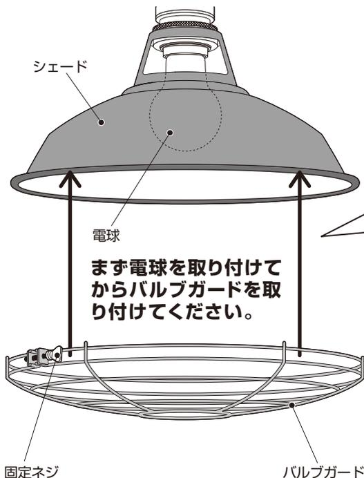
まず電球を取り付けてからバルブガードを取り付けてください。
