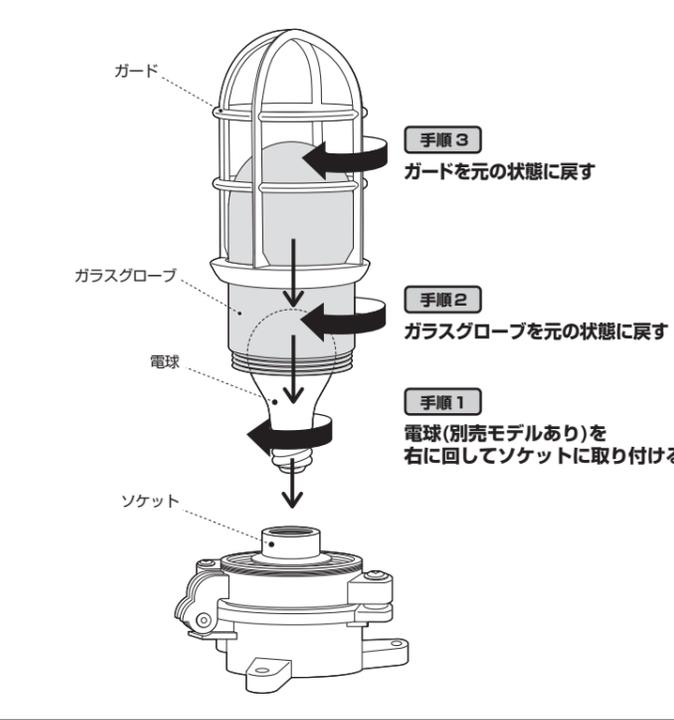
3 電源プラグをコンセントに差し込み、電源スイッチをオンにして点灯を確認してください。
